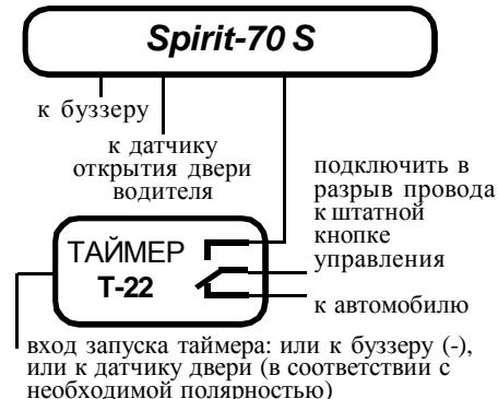
При таком способе подключения штатная кнопка отключается от автомобиля и переключается на вход иммобилайзера на время, заданное T-22, или после открытия двери, или после касания ЭК к ГС.
