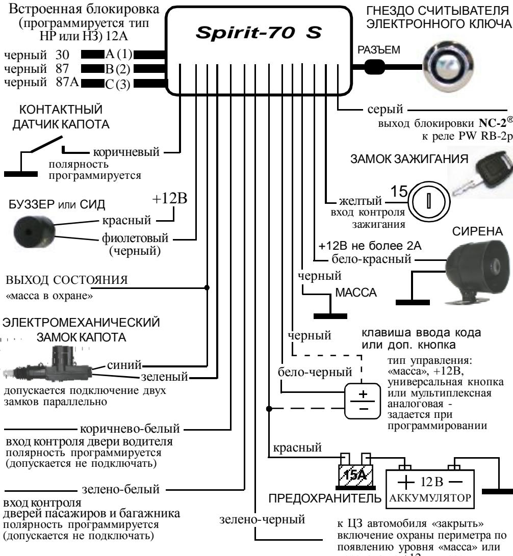
При программировании полярности входов контроля дверей водителя и/или пассажиров изменяется полярность внутренней подтяжки этих входов.
